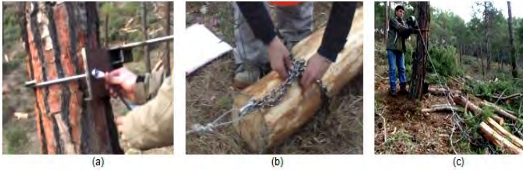
Şekil 3. Kollu el vincinin kurulumu (a), ürünü bağlama (b), bölmeden çıkarma (c)
