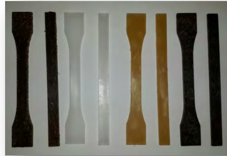
Şekil 2. Üretilen kompozit test örnekleri
