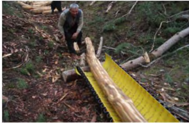
Şekil 3. Odun hammaddesinin olukta kaydırılması
