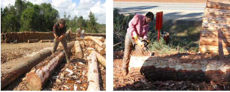
Şekil 5. Tomruğun balta ve motorlu testere ile soyulma aşamaları
