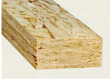
Şekil 3. Tabakalanmış şerit kereste (URL-2)
