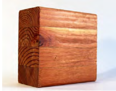
Şekil 1. Dört tabakalı glulam örneği (URL-1)
