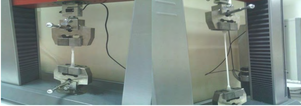
Şekil 3. Kompozit malzemenin çekme eğilme test aletine yerleştirilmesi işlemi.
