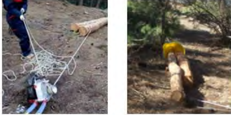
Şekil 4. Benzinli el vinci ile sürütme
