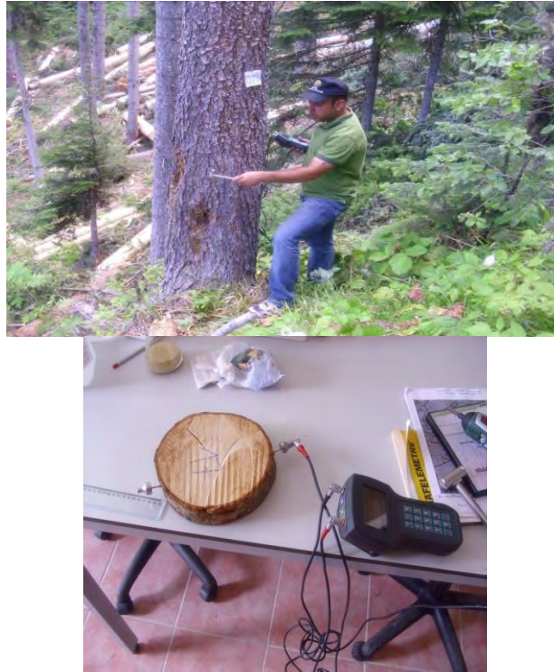
Şekil 1. Dikili ağaçlarda ve odun disklerinde IML Mikroçekiç cihazı ile yapılan ultrasonik ölçümler.
