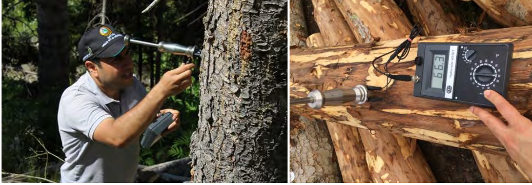
Şekil 2. Odun rutubet ölçer cihazı ile ağaçların rutubet miktarının tespiti.
