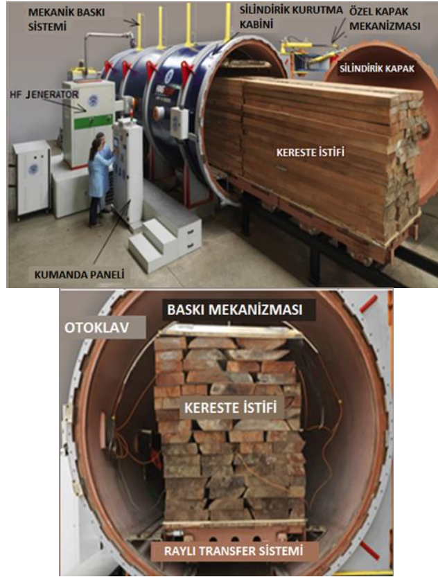
Şekil 1. YF-V Kurutmanın Genel Görünümü ve Kerestelerin Fırın İçerisindeki Durumu (Recep Sivrikaya co., Düzce-Türkiye)
