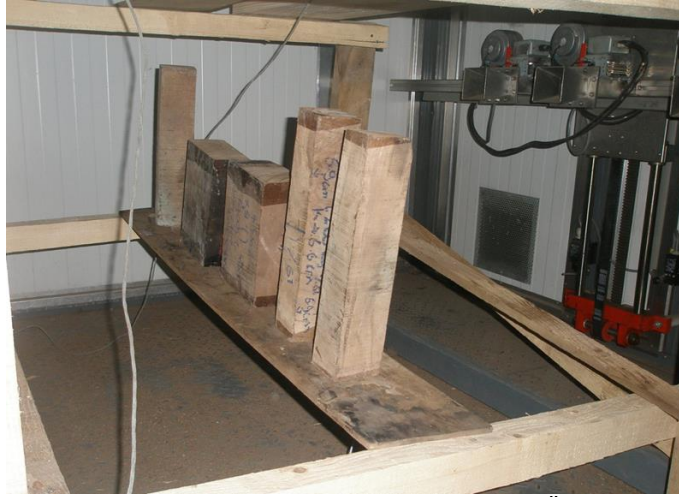
Şekil 3. Kurutma öncesinde MD-K Fırınındaki Ceviz ve Meşe Örnekleri (Recep Sivrikaya Ltd. Şti., Düzce-Türkiye)
