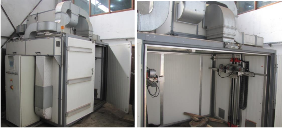
Şekil 2. MD-K Kurutmanın Genel Görünümü ve Fırının İç Yapısı (Recep Sivrikaya Ltd. Şti., Düzce-Türkiye)
