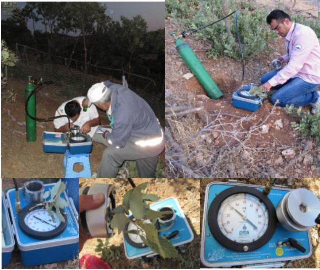
Şekil 3. Şafak öncesi ve gün ortasında bitkilerdeki su potansiyelinin ölçülmesi
